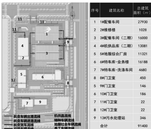
图3 外部流线及组成建筑示意图
