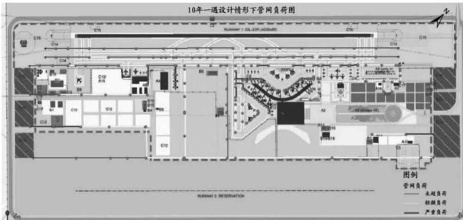
图7 10年一遇设计降雨情形下管网负荷情况
