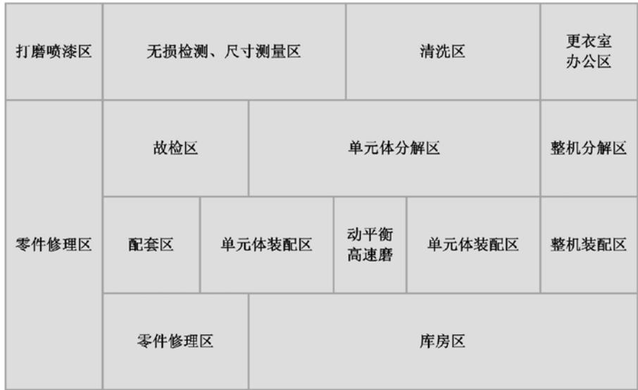
图2 固定式分解/装配工艺布局示意图
