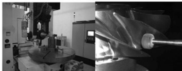
图4 数控磨削抛光整体叶盘
