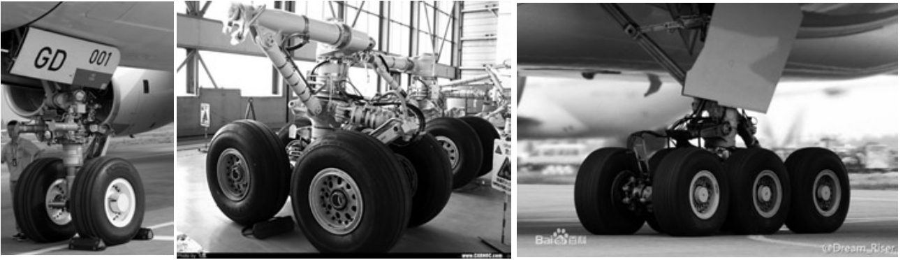
图1 常见飞机轮组(二轮、四轮、六轮)
