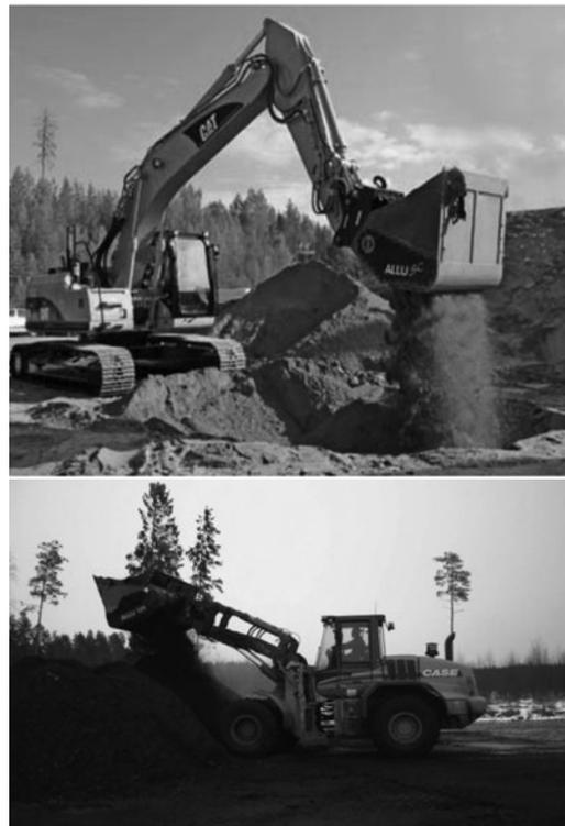
图7 ALLU设备破碎筛分施工现场照片
